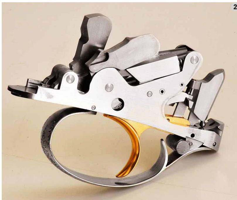
di bascula, sono ricavati scassi sui quali si impegnano i tasselli comandati dalla chiave di apertura. Sui ramponi anteriori sono ricavate le sedi dei ramponi di basculaggio. Al centro del fondo di bascula scorre l'unica slitta di caricamento dei cani, sospinta dal dente della croce quando si bascula il fucile.
