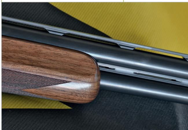
La bindella superiore è rabescata antiriflesso, da 10 mm, e termina con un generoso mirino in fibra ottica di colore rosso che risulta sempre ben visibile, in ogni condizione di luce. L'esame esterno della volata evidenzia la presenza di strozzature fisse; in opzione è possibile richiedere l'adozione di strozzatori interni intercambiabili
