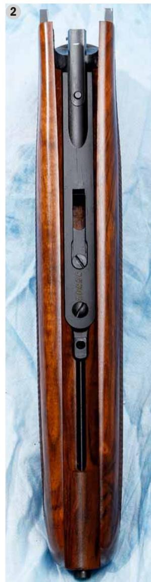
1 2 L'asta è sottile e rotonda e ha un peso di 287 grammi, con pulsante per l'apertura in punta.
