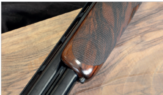
L'astina è tonda da tiro, molto comoda per la presa della mano debole; il pulsante di sgancio a pompa è affidato ad un piccolo bottoncino, discreto e quasi invisibile, situato all'apice della stessa
